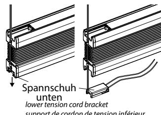
unteren Spannschuhe aus der Schiene nehmen und auf die unten montierten Befestigungsplättchen schieben, bis sie einrasten
