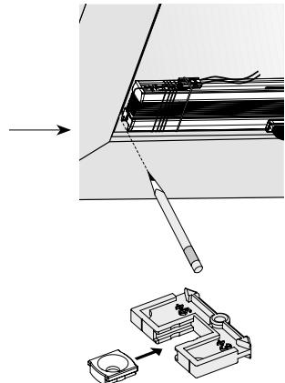
Montagehilfe je nach Fenstertyp – wie bereits bei den Clips beschrieben – mit „+5“ oder „+3“ an die Vorderkanne des Fensters und Ihrer Markierung der Plisseebreite anlegen. Clips festschrauben. Montagehilfe abziehen.
