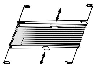
Gespannte Plissee-Anlagen schließt bzw. öffnet man durch verschieben des Bediengriffes.
