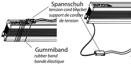
Gummiband entfernen und die Spannschuhe abwickeln
