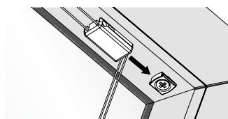
oberen Spannschuhe auf die oben montierten Befestigungsplättchen schieben, bis sie einrasten
