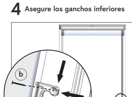
Coloque un gancho (c) en la esquina inferior de la ventana y asegúrelo con el tornillo (b). Repita la operación en el otro costado.
