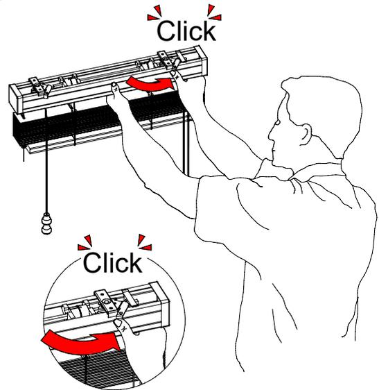
Abb. 8 - Spannschuhmontage bei Seitenführung
